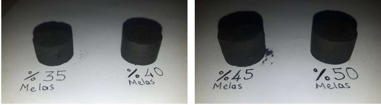
Görsel 5. Farklı oranlarda melas içeren kurutulmuş karbon-melas briketler
