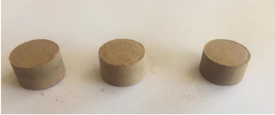
Görsel 4. Atık MDF tozundan elde edilen briketler
