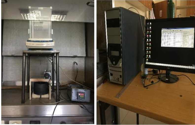
Görsel 3. Deneylerde kullanılan izotermal yakma sistemi
