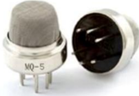
Görsel 1. LPG/Propan Gaz Sensörü MQ-5 [16]
