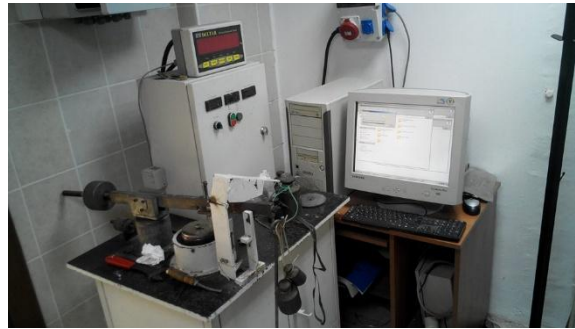
Şekil 2. Pim-disk aşınma test cihazı
