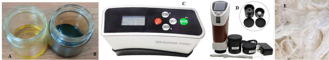
Şekil 1. Tarçınlı ahşap yağı (A), antik ahşap yağı (B), beyazlık indeksi (C), renk ölçüm cihazı (D) ve üstüpü (E)
