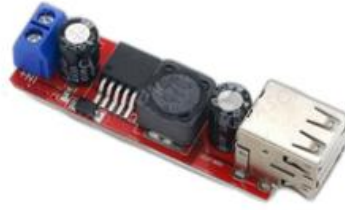
Görsel 6. 5V 3A DC-DC Buck Tipi Çift USB Voltaj Dönüştürücü [31]
