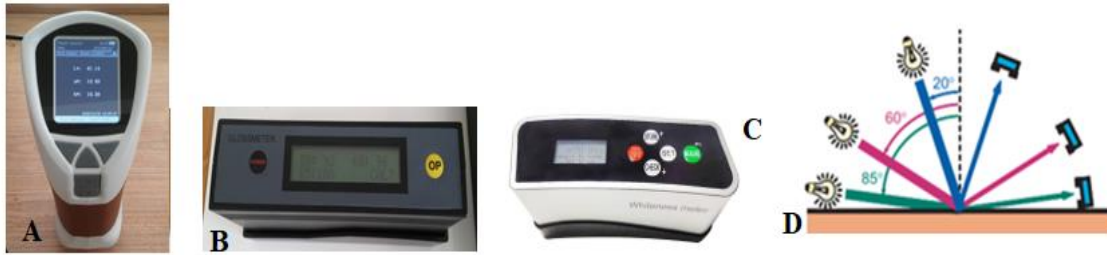
Şekil 1. Renk ölçüm cihazı (A), parlaklık ölçüm cihazı (B), beyazlık indeksi ölçüm cihazı (C) ve parlaklık ölçüm açıları (Streitberger ve Dössel, 2008) (D)
