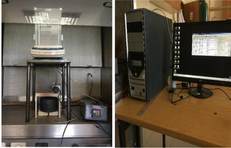
Görsel 3. Deneylerde kullanılan izotermal yakma sistemi
